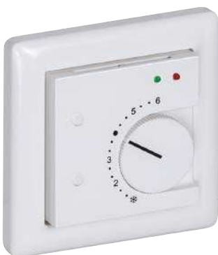
FSTF xx P2L2T Versione con sonda, potenziometro (1 kOhm, max. 0,1 W), 2 diodi luminosi (verde, rosso) e 2 pulsanti (max. 24 V DC, max. 10 mA)
